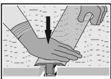
(vii) Pour les combinaisons de plancher plus sous-couche de – 10 mm à 14 mm d'épaisseur – AUCUNE CALE de 2 mm n'est requise. Retirez-la du rail.
