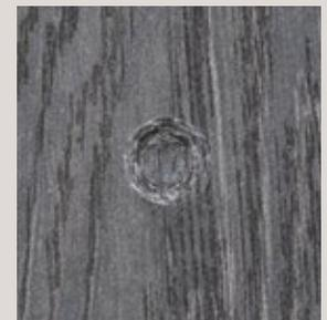
TESTÉ: Essai de rendement de dureté Janka ASTM D1037 utilisant 1200 livres-force.
